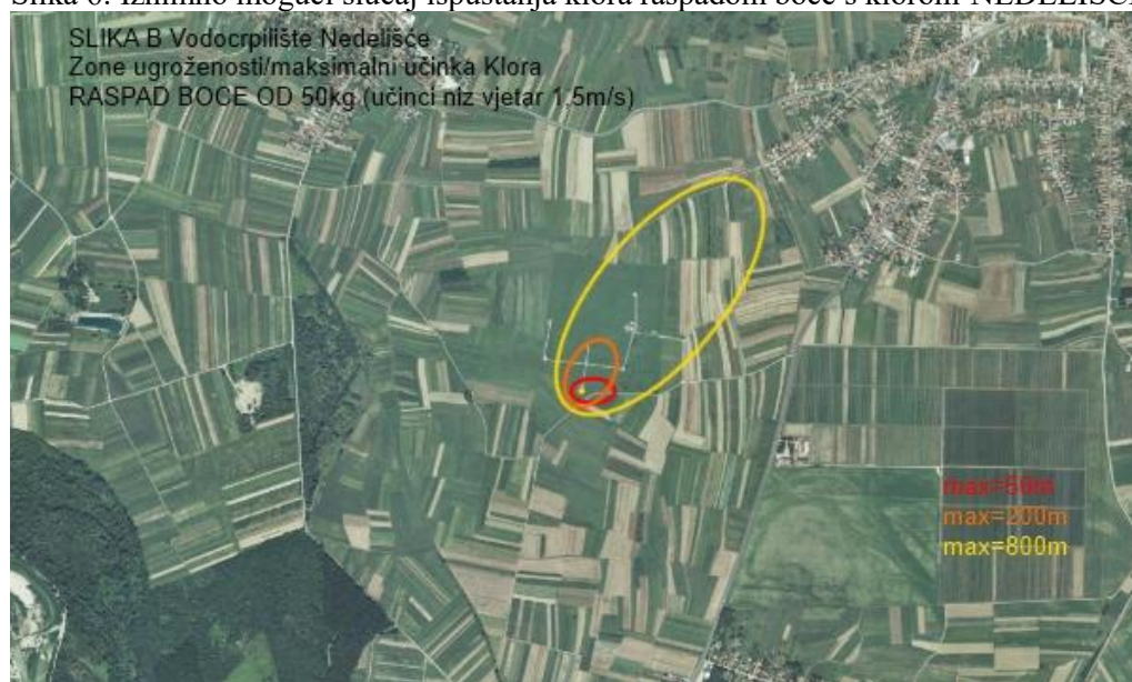
Slika 6: Iznimno mogući slučaj ispuštanja kloro raspadom boce s klorom-NEDELIŠĆE-
